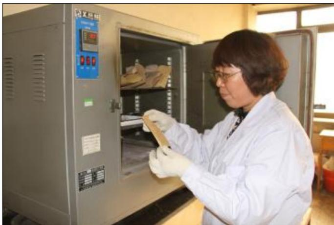
近日,技术中心应用研究室积极开拓试验研究业务范围,在完成原有试验任务的基础上,增加了沁源、阳城、西山、古县等合作矿山铝土矿化验分析任务。图为技术中心应用研究室员工正在烘干处理矿石样品。
